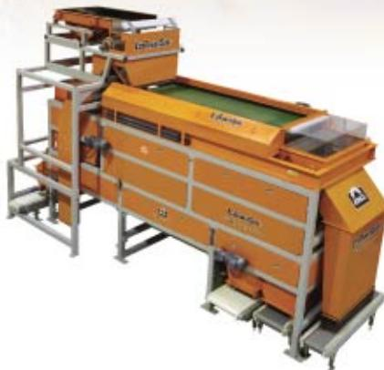
EcoTowerSort™用不同的分类技术模块分离铝，不锈钢，铜线，重物质甚至是回收不锈钢和塑料涂层电线。通常结构包括稀土滚筒磁选机，涡流分选机，导电感应分离器或近红外传感器（NIR）。
