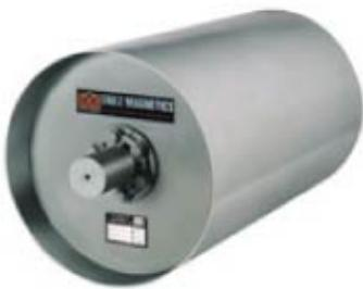
新型补偿磁极产生的磁场可从靠皮带输送的非磁性材料中清除有害的铁质。此设备易于安装，可自行清杂，磁场强度符合工业要求。可提供多达80种的直径和宽度组合。直径可从8到36英寸 (203到914毫米)，皮带宽度可为8到60英寸 (203到1524毫米)。艺利还可提供电磁滑轮。
